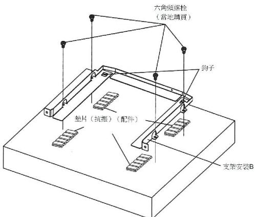
**1.2** 如機台深度不足以固定主支架最外的兩顆螺絲，請在主支架兩旁適當位置加裝 "L" 形鋁角碼以 3/16 吋鍋釘釘在主支架外邊，放上避震膠墊後以螺絲固定在機台上。
