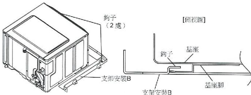
(4) 用六角頭螺栓與墊圈鎖緊支架安裝 A 與支架安裝 B。
