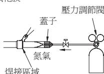
焊接材料使用不需要助焊劑的磷銅。不要使用助焊劑焊接配管。如果助焊劑是氯化物，會腐蝕配管。
