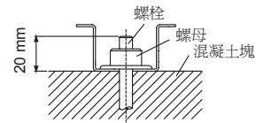
用螺栓確實地固定在混凝土上。（使用 4 套市售 M10 螺栓、螺母和墊片。）
